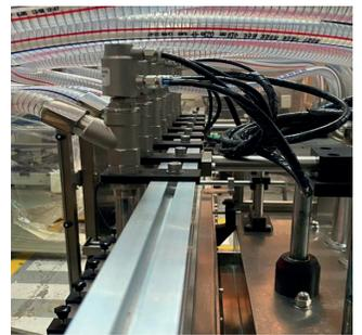
La máquina de llenado automática de pistones de cabezal múltiple, es una nueva generación de máquinas de llenado. Cuenta con PLC para controlar la interfaz, presenta un diseño novedoso, una apariencia amigable y es muy sencilla de manejar. Especialmente utilizada en el llenado de diversos líquidos, viscosos como salsas, líquidos, cremas y entre otros productos de tipo alimenticio, farmacéutico y/o cosmético.
