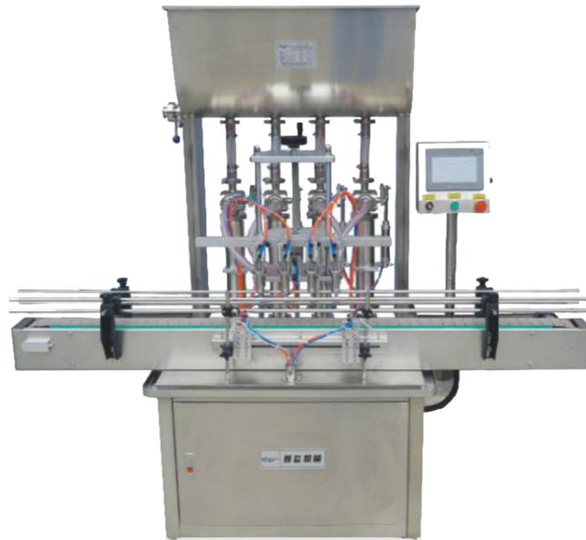
La máquina de llenado automática de pistones de cabezal múltiple, es una nueva generación de máquinas de llenado. cuenta con plc para controlar la interfaz, presenta un diseño novedoso, una apariencia amigable y es muy sencilla de manejar.
