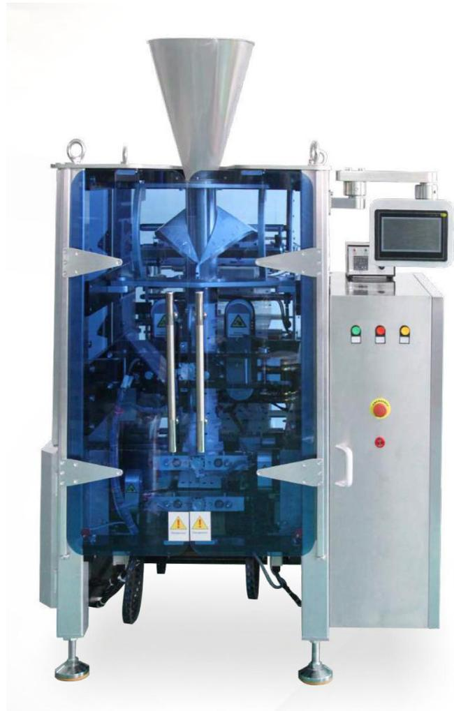
La empacadora marca Tedmaq es una maquina diseñada para realizar el procedimiento completo de embolsado, impresión de la fecha y lote (fechado), finalizando con un producto totalmente terminado el cual sale automáticamente. Adecuado para el embalaje de productos como polvos, granos y líquidos etc.
