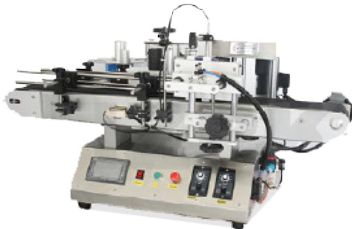
Esta máquina etiquetadora es usada para envases cilíndricos, como botellas plásticas o de vidrio. adopta el dispositivo de fricción de rodillos para garantizar la precisión de la etiqueta.
