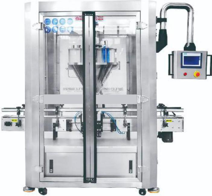
Nuestra dosificadora de polvo Automática de TEDMAQ SAS de un solo cabezal está diseñada de acuerdo con el estándar nacional GMP. La máquina se puede combinar con la máquina embotelladora, la máquina prensadora de tapas, la máquina etiquetadora y otros equipos para componer la tubería. Es adecuada para llenar materiales en polvo como leche en polvo, glucosa, proteína en polvo, cacao en polvo, café en polvo, arroz en polvo, bebidas sólidas, etc.
