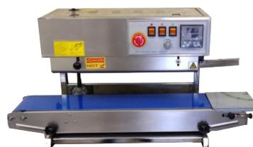
Máquina de banda continua que puede sellar películas de plástico hechas de diversos materiales. Tiene un codificador de tinta sólida, es capaz de imprimir a alta velocidad.
