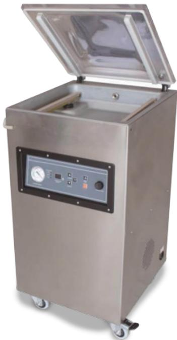
Esta línea de empaque es de una barra de sellado tablero electrónico que controla tiempos de sellado y de vacío, estructura en acero inoxidable.
